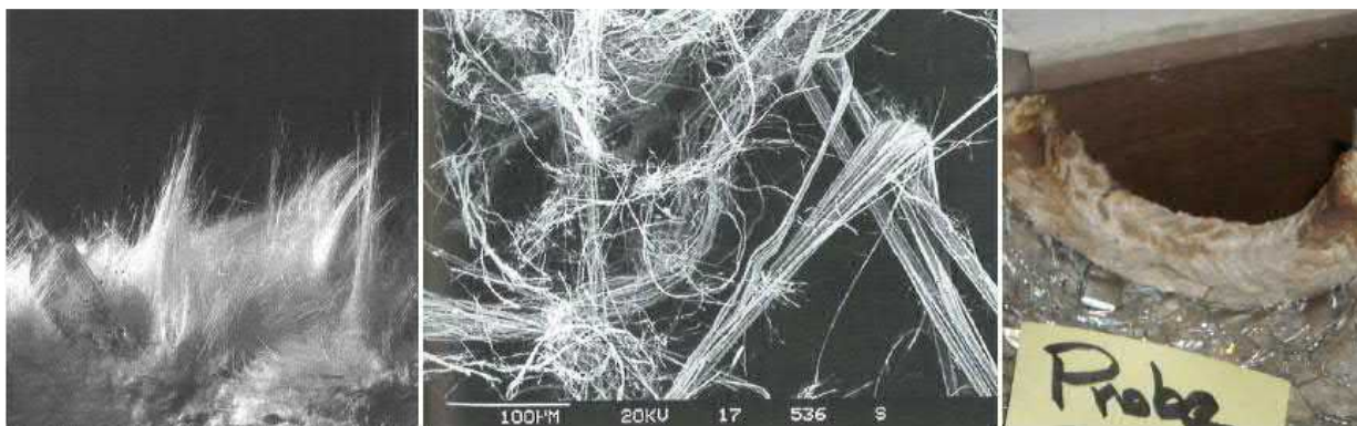
Anhang A-1: Chrysotil als Beispiel einer Art von Asbestfasern: Links als Spaltfüllung, wie es in der Natur vorkommt. Unter starker Vergrösserung zeigt sich, dass die einzelnen Fasern oft aus zahlreichen Einzelfibrillen zusammengesetzt sind (Mitte). Rechts als Dichtungsschnur (Zopf), wie es z.B. in einer Rohrisolation verwendet wurde.
